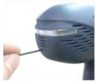
※ 電池パックを取付けてスロットルレバーを引いた後、ツール背面のLEDが青色点滅した事、または黄色点滅している事を確認し、ペアリングボタンを押してください。
